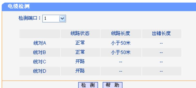
图 4-35 电缆检测
