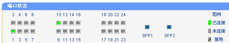
图 4-1 端口面板状态（无 SFP 模块）
